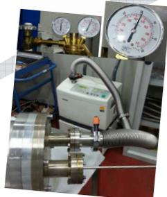
Test di pressurizzazione fino a 500 bar
