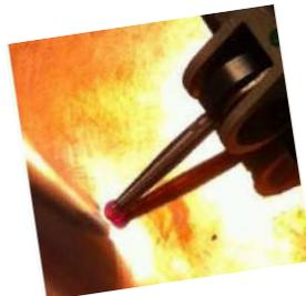
Test con prima opzione di finitura: elettrodeposizione di uno strato di rame
